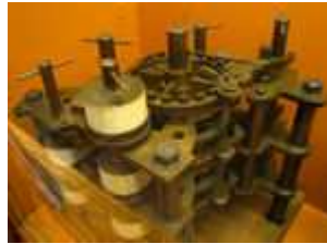
Figura 2: Réplica (parte) do Calculador Diferencial criado por Charles Babbage
